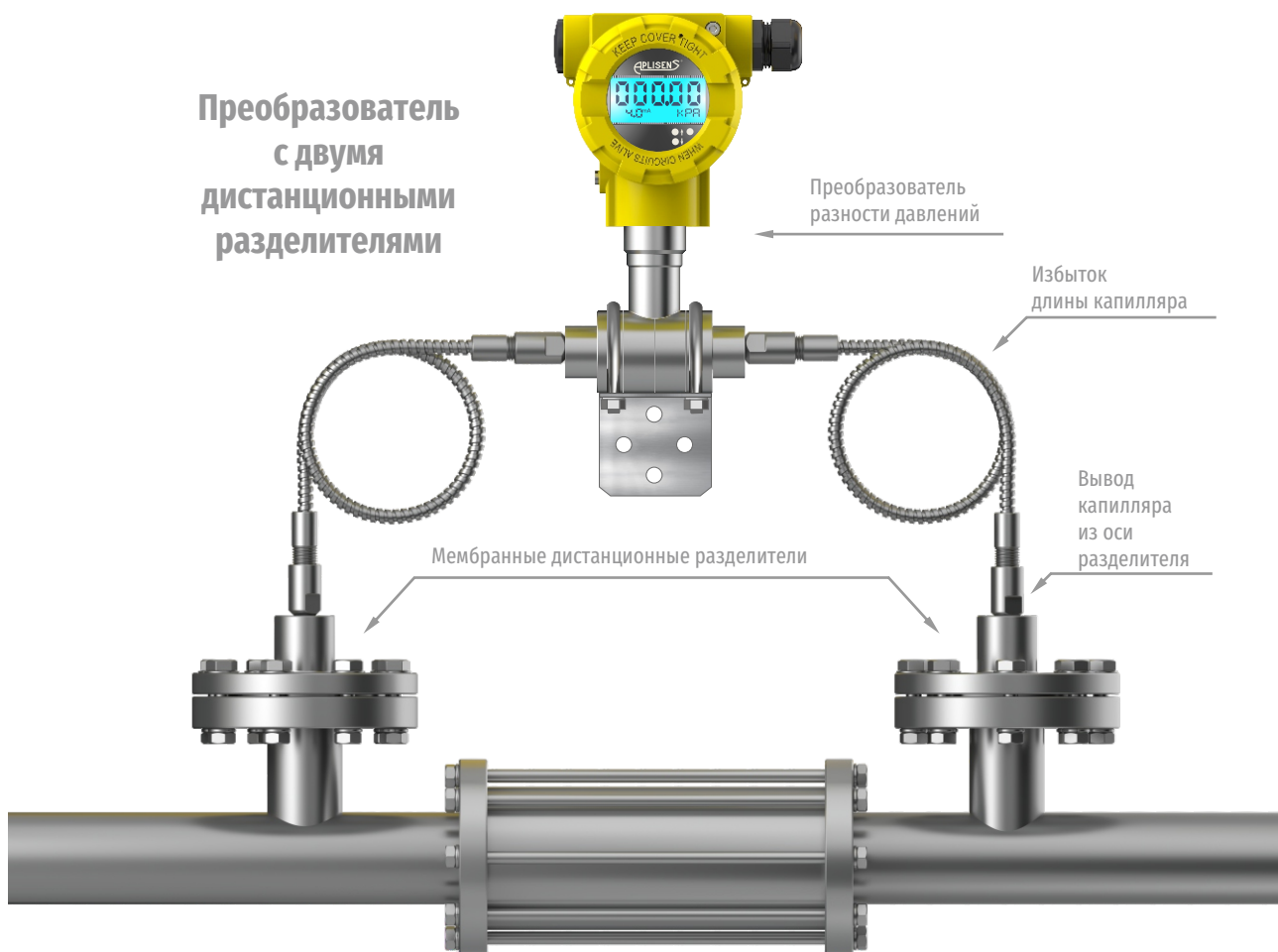
Пример измерения перепада давления на фильтре
