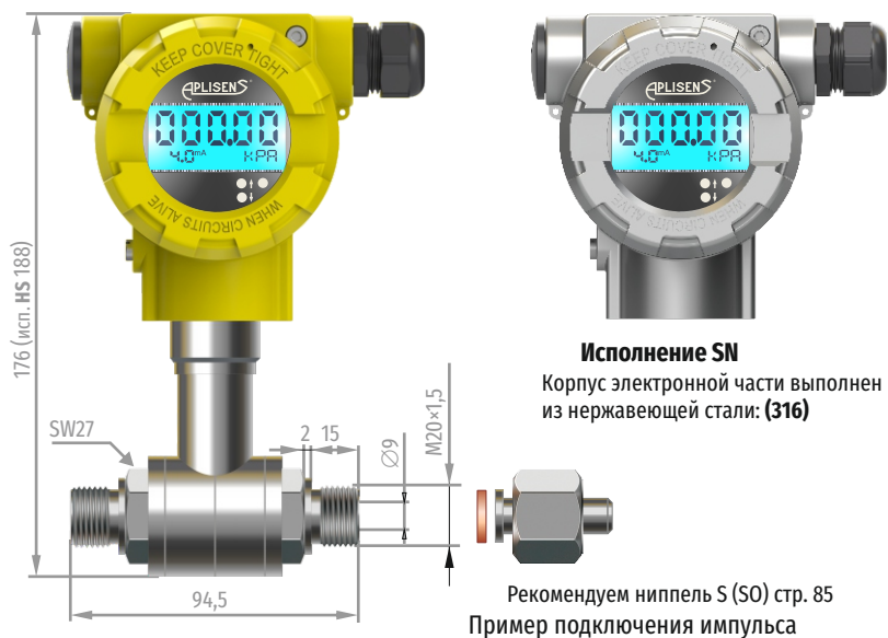
Преобразователь APR-2000AL Присоединение Р со штуцерами. Допустимое статическое давление 4 МПа
